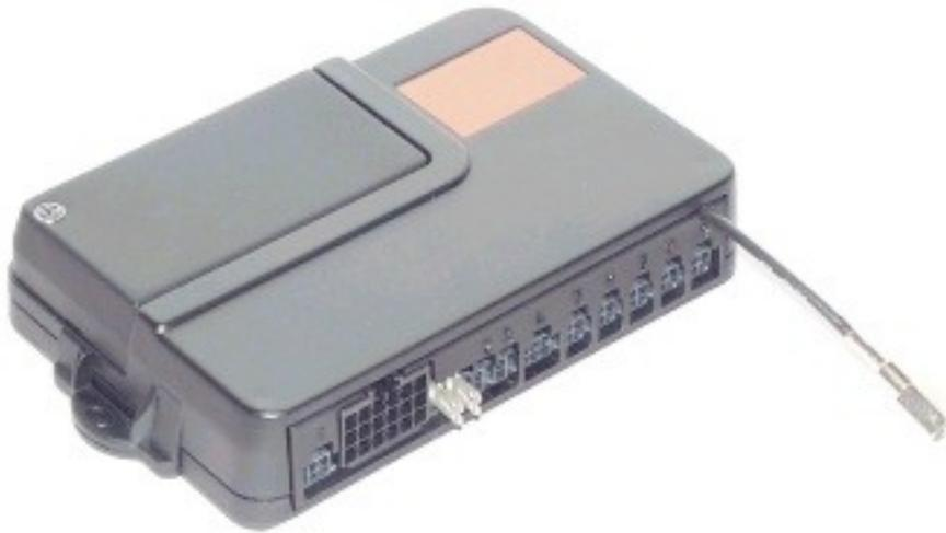
Nel caso di studio l'implementazione del MIB è finalizzata a monitorare lo stato della centralina e dei suoi componenti. Il MIB si trova all'interno di ogni centralina situata all'interno del veicolo e comunica con una centrale remota tramite SMS inviati dal GSM. La centralina quindi è un sistema di TTS (Trouble Tickets System).
